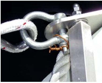
Der Schleppanker wird beiderseits angeschäkelt
